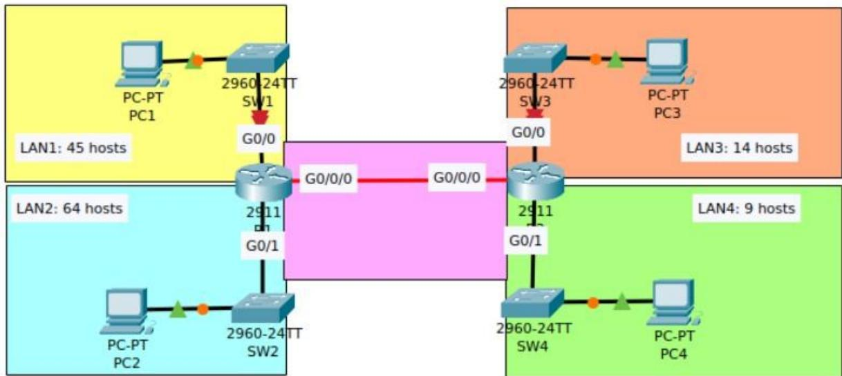
Le réseau 192.168.5.0/24 est constitué de 4 LAN ainsi que 2 routeurs qui permettent aux différents réseaux de communiquer entre eux
